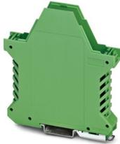
Tragschienengehäuse, Gehäuseunterteil mit Metallfußriegel, hohe Bauform, mit Lüftungsschlitzen, Breite: 17,6 mm, Höhe: 99 mm, Tiefe: 107,3 mm, Farbe: grün (ähnlich RAL 6021), Querverbindung: ohne Busverbinder, Polzahl Querverbinder: nicht relevant
