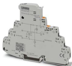
Überspannungsschutz mit integrierter Statusanzeige und Messertrennung für drei Signaladern mit gemeinsamen Bezugspotenzial. Für HF-Anwendungen und Telekommunikationsschnittstellen ohne Speisespannung (bis zu 90 MBit/s). Indirekte Erdung über Gasableiter, HART-fähig. In sicherheitsgerichteten Kreisen bis SIL 3 einsetzbar.
