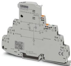
Überspannungsschutz mit integrierter Statusanzeige und Messertrennung für einen 2-adrigen erdpotenzialfrei betriebenen Signalkreis, z. B. 0(4)...20 mA Stromschleife. Indirekte Erdung über Gasableiter, HART-fähig. In sicherheitsgerichteten Kreisen bis SIL 3 einsetzbar.
