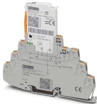
Überspannungsschutz, bestehend aus Schutzstecker und Basiselement, mit integrierter Statusanzeige und Trennmesser für einen 2-adrigen erdpotenzialfrei betriebenen Signalkreis, z. B. 0(4) ... 20 mA Stromschleife, EX e-Zulassung für Zone 2, HART-fähig. In sicherheitsgerichteten Kreisen bis SIL 3 einsetzbar.
