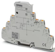
Überspannungsschutz mit integrierter Statusanzeige und Messertrennung für drei Signaladern mit gemeinsamen Bezugspotenzial. Für HF-Anwendungen und Telekommunikationsschnittstellen ohne Speisespannung (bis zu 90 MBit/s). In sicherheitsgerichteten Kreisen bis SIL 3 einsetzbar.
