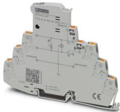
Überspannungsschutz mit integrierter Statusanzeige und Messertrennung für einen 2-adrigen erdpotenzialfrei betriebenen Signalkreis mit hohem Nennstrom, KNX geeignet. In sicherheitsgerichteten Kreisen bis SIL 3 einsetzbar.
