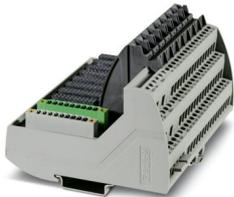
8-kanaliges VIP I/O-Marshalling-Basiselement für den universellen Einsatz. Alle Anschlüsse als Schraubanschlusstechnik. Mit dem COMBICON-Steckverbinder kompatibel zur Honeywell C300- und RUSIO-Serie. Markierung für die Kanäle 9-16.
