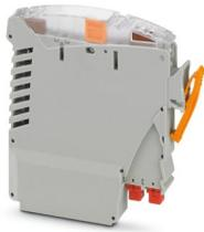
Sicherungsmodul für VIP I/O-Marshalling-Basiselemente mit austauschbaren 0,5-A-Sicherungen im Feldgeräte-Versorgungspfad und im Signalpfad. Integrierte Testpunkte und ein Trennmesser erlauben die unterbrechungsfreie Signalmessung. HART-transparent.
