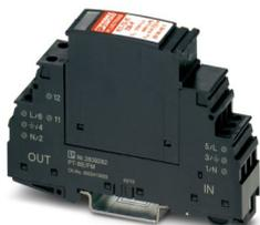
Überspannungsschutz Typ 3, als Geräteschutz für Endgeräte in IT-Systemen, Defektsignalisierung und Fernmeldekontakt. Ausführung: 230 V AC
