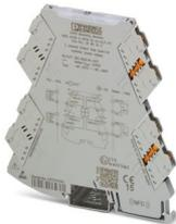
2-kanaliger ausgangsschleifengespeister 2-Wege-Speisetrenner mit steckbarer Anschluss technik zur galvanischen Trennung von Analogsignalen. Eingangssignal = Ausgangssignal: 0(4) mA ... 20 mA. Push-in-Anschluss technik.
