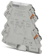
1-kanaliger ausgangsschleifengespeister 2-Wege-Speisetrenner mit steckbarer Anschlussstechnik zur galvanischen Trennung von Analogsignalen. Eingangssignal = Ausgangssignal: 0(4) mA ... 20 mA. Schraubanschlusstechnik.
