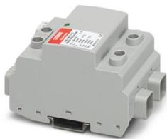
Blitzstrom- / Überspannungsableiter für 2-polige isolierte und geerdete PV-Gleichspannungssysteme 600 V DC, für Tragschienenmontage, mit Fernmeldekontakt, temperaturüberwachte Schutzelemente, Statusmeldung am Modul.
