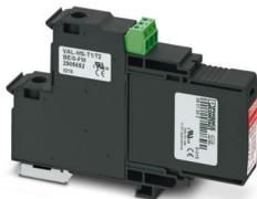
Universeller steckbarer Blitzstrom- / Überspannungsableiter auf Varistorbasis für 1-phasige Stromversorgungsnetze mit gemeinsamem N und PE (2-Leitersystem: L1, PEN), mit Fernmeldekontakt.
