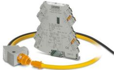
Set bestehend aus einem 4-Wege-Trennverstärker mit Push-in-Anschluss-technik und einer Rogowski-Spule mit 300 mm Länge / 95 mm Durchmesser zur AC-Strommessung auf Stromschienen und Starkstromleitungen.
