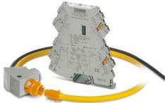
Set bestehend aus einem 4-Wege-Trennverstärker mit Schraubanschlusstechnik und einer Rogowski-Spule mit 300 mm Länge / 95 mm Durchmesser zur AC-Strommessung auf Stromschienen und Starkstromleitungen.
