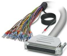
Konfektioniertes, geschirmtes Rundkabel; Anschluss 1: Einzeladern (37-polig) (Die Adern sind beschriftet und mit Aderendhülsen versehen. Das Schirmgeflecht ist auf ein separates Kabelende herausgeführt.); Anschluss 2: D-SUB-Buchsenleiste (1x 37-polig); Kabellänge: 20 m
