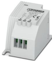
Überspannungsableiter Typ 2 zur universellen Montage in Leuchten und Kabelanschlusskästen. Speziell für Isolationsschutzklasse II mit optischer Defektmeldung. Installation in Stich- oder Durchgangsverdrahtung. Ausführung: 230 V AC
