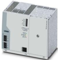
Unterbrechungsfreie Stromversorgung 1AC/1AC/750 VA mit integrierter Batterie, Blei-AGM, VRLA-Technologie, 24 DC, 4 Ah für 120 V AC-Anwendungen.
