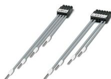
Kabelsatz für Einspeisemodul MINI MCR-SL-PTB-FM (Artikel-Nr.: 2902958) und Fehlermeldemodul MINI MCR-SL-FM-RC-NC (Artikel-Nr.: 2902961), zur Verwendung auf dem Termination Carrier für die Module der Serie MINI-Analog.
