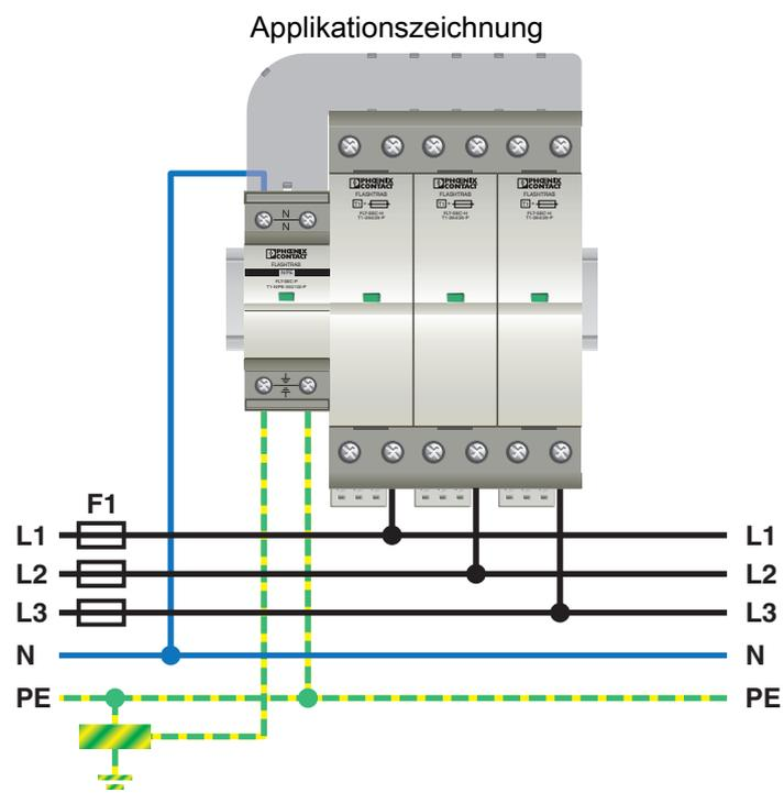
Aufbau einer 3+1-Schaltung für TN-S/-TT-Systeme mit einer N/PE-Funkenstrecke und Verdrahtungsbrücke.
