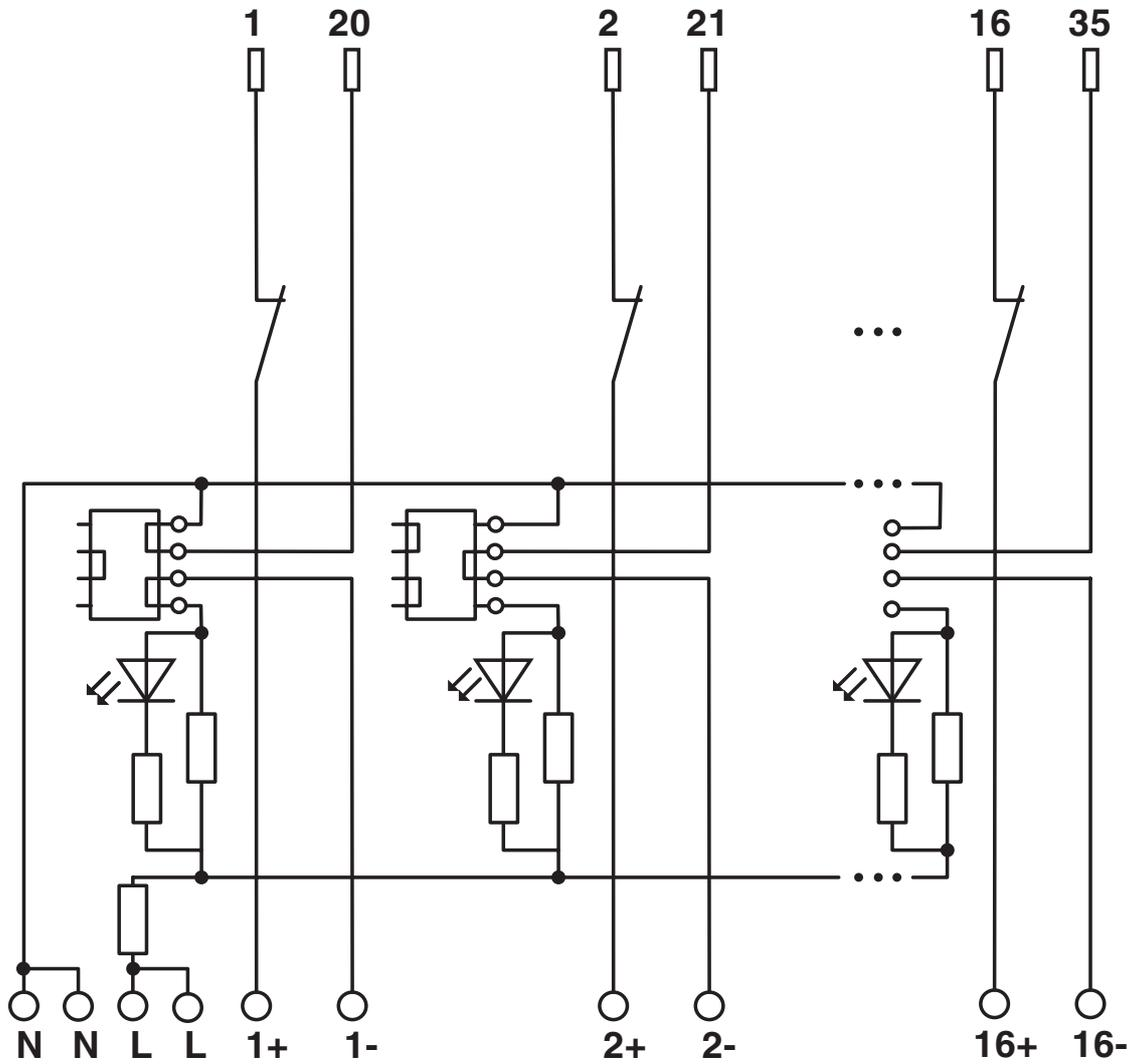
Kanal 1 zeigt die Steckbrücke in der intern versorgten Rangierkonfiguration.
