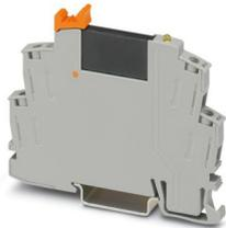
Vormontiertes Solid-State-Relaismodul mit Schraubanschluss, bestehend aus: Relaissockel mit Auswerfer und steckbarem Miniatur-Solid-State-Relais. Eingangsspannung: 24 V DC. Ausgang: 3-48 V DC/100 mA
