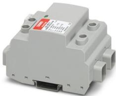
Überspannungsableiter für 2-polige isolierte und geerdete PV-Gleichspannungssysteme 1500 V DC, für Tragschienenmontage, mit Fernmeldekontakt, temperaturüberwachte Schutzelemente, Statusmeldung am Modul.
