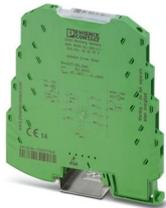
3-Wege-Ausgangstrennverstärker zur Übertragung von 0/4 ... 20 mA-Signalen von der Steuerung zu einer im Feld befindlichen Bürde bei gleichzeitiger galvanischer 3-Wege-Trennung zwischen Eingang, Ausgang und Versorgung, mit Schraubanschluss
