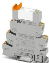
PLC-INTERFACE, Hybrid-Solid-State-Relais inkl. Bypassrelais mit Push-in-Anschluss, zur Montage auf Tragschiene NS 35/7,5, Eingang: 24 V DC, Ausgang: 12 V DC - 250 V DC/ 10 A
