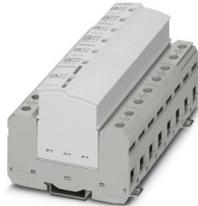
Steckbare Blitzstrom- und Überspannungsableiterkombination, gem. Typ 1+2 / Class I+II, für 3-phasige Stromversorgungsnetze, mit separatem N und PE (L1, L2, L3, PE, N).
