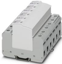
Steckbare Blitzstrom- und Überspannungsableiterkombination, gem. Typ 1+2 / Class I+II, für 3-phasige Stromversorgungsnetze, mit kombiniert verlegtem PE und N in einem Leiter (L1, L2, L3, PEN).
