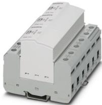
Steckbarer und leckstromfreier Blitzstromableiter, gem. Typ 1 / Class I, für 3-phasige Stromversorgungsnetze, mit kombiniert verlegtem PE und N in einem Leiter (L1, L2, L3, PEN).
