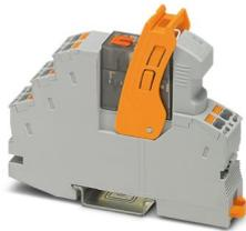
Vormontiertes Relaismodul mit Push-in-Anschluss, bestehend aus: Relaissockel, Relaishaltebügel, steckbarem Entstörmodul und Leistungskontaktrelais mit Prüftaste und integrierter Status-LED. Kontaktausführung: 2 Wechsler. Eingangsspannung: 230 V AC
