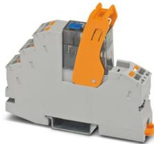
Vormontiertes Relaismodul mit Push-in-Anschluss, bestehend aus: Relaissockel, Relaishaltebügel und Leistungskontaktrelais mit Prüftaste, integrierter Status-LED und Freilaufdiode. Kontaktausführung: 2 Wechsler. Eingangsspannung: 24 V DC
