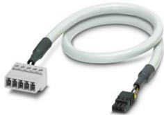
Konfektioniertes, geschirmtes Rundkabel; Steuerung: PLC logic (Verbindung zum Tragschienen-Busverbinder); Anschluss 1: COMBICON-Steckverbinder (1x 3-polig); Anschluss 2: COMBICON-Steckverbinder (1x 5-polig); Kabellänge: 0,3 m
