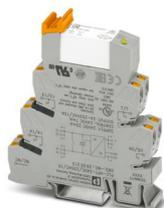
PLC-INTERFACE, Hybrid-Solid-State-Relais inkl. Bypassrelais mit Push-in-Anschluss, zur Montage auf Tragschiene NS 35/7,5, Eingang: 24 V DC, Ausgang: 24 V AC - 253 V AC/ 10 A
