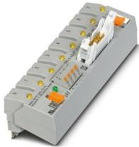
V8-Adapter für 8 x RIF-1 Relaissockel, Steuerung: SPS-Systemverkabelung von Ausgangskarten, Anschluss 1: Push-in-Anschluss 4x, Anschluss 2: IDC/FLK-Stiftleiste 1x 14-polig, Anschluss 3: Steckanschluss, Anzahl der Kanäle: 8, Ansteuerlogik: plusschaltend
