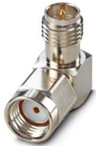
Antennenadapter, Frequenzbereich: 0,3 GHz ... 6 GHz, Anschluss: RSMA (male) -> RSMA (female), 90° gewinkelt
