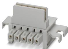
Tragschienen-Busverbinder, Farbe: grau, Nennstrom: 8 A (parallele Kontakte), Bemessungsspannung (III/2): 125 V, Polzahl: 5, Artikelfamilie: TBUS5-17,5..., Rastermaß: 3,81 mm, Montage: Tragschienenmontage, Verriegelung: ohne, Befestigungsart: ohne, Verpackungsart: verpackt im Karton, Artikel mit vergoldeten Kontakten, Busstecker zur Verbindung mit Elektronikgehäusen, 5 Parallelkontakte
