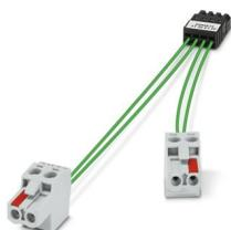
Kabelsatz zur Signalübertragung auf dem Termination Carrier für die zweikanaligen Module oder Module mit doppeltem Ausgang der Serie MACX Analog Ex. Anschluss der Klemmstellen 3.1 und 3.2 sowie 2.1 und 2.2 (Signalübertragung) an die Signalplatine.
