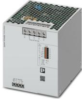
Primär getaktete Stromversorgung QUINT POWER mit wählbarer Ausgangskennlinie, SFB Technology (Selective Fuse Breaking) und NFC-Schnittstelle, Eingang: 3-phasig, Ausgang: 24 V DC / 40 A
