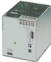
Primär getaktete Stromversorgung QUINT POWER zur Tragschienenmontage, mit wählbarer Ausgangskennlinie und SFB Technology (Selective Fuse Breaking), Schutzlackierung und integriertem Entkopplungs-Mosfet, Eingang: 1-phasig, Ausgang: 24 V DC / 40 A
