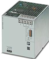
Primär getaktete Stromversorgung QUINT POWER mit wählbarer Ausgangskennlinie, SFB Technology (Selective Fuse Breaking) und NFC-Schnittstelle, Eingang: 1-phasig, Ausgang: 48 V DC / 20 A
