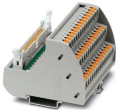
VARIOFACE-Modul, mit Push-in-Anschluss und Flachbandkabel-Steckverbinder, zur Montage auf NS 35-Tragschienen, mit Stiftleiste sowie kurzen und langen Verriegelungsbügeln für Buchsenleisten, Polzahl: 40, mit LED
