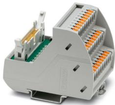
VARIOFACE-Modul, mit Push-in-Anschluss und Flachbandkabel-Steckverbinder, zur Montage auf NS 35-Tragschienen, mit Stiftleiste sowie kurzen und langen Verriegelungsbügeln für Buchsenleisten, Polzahl: 26, mit LED
