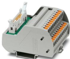
VARIOFACE-Modul, mit Push-in-Anschluss und Flachbandkabel-Steckverbinder, zur Montage auf NS 35-Tragschienen, mit Stiftleiste sowie kurzen und langen Verriegelungsbügeln für Buchsenleisten, Polzahl: 20, mit LED
