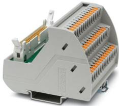
VARIOFACE-Modul, mit Push-in-Anschluss und Flachbandkabel-Steckverbinder, zur Montage auf NS 35-Tragschienen, mit Stiftleiste sowie kurzen und langen Verriegelungsbügeln für Buchsenleisten, Polzahl: 40
