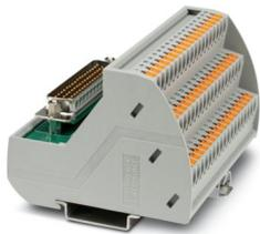
VARIOFACE-Modul, mit Push-in-Anschlüssen und D-SUB-Miniatur-Stiftleiste, zur Montage auf NS 35-Tragschienen, Polzahl: 50
