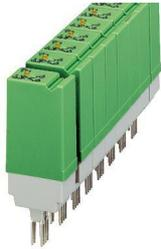
Steckbares Leistungs-Solid-State-Relais, mit Leuchtanzeige und Schutzbeschaltung im Ein- und Ausgangskreis, Eingang: 120 V AC, Ausgang: 12-60 V DC/max. 3 A, steckbar auf Grundklemmenblöcke
