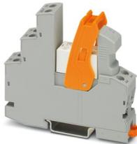
Vormontiertes Relaismodul mit Schraubanschluss, bestehend aus: Relaissockel, Leistungskontaktrelais, steckbarem Anzeige-/ Entstörm modul und Haltebügel. Kontaktausführung: 2 Wechsler. Eingangsspannung: 120 V AC
