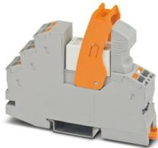
Vormontiertes Relaismodul mit Push-in-Anschluss, bestehend aus: Relaissockel, Leistungskontaktrelais, steckbarem Anzeige-/ Entstörm modul und Haltebügel. Kontaktausführung: 1 Wechsler. Eingangsspannung: 120 V AC
