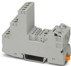
Relaissockel RIF-2..., für Industrierelais mit 2- oder 4-Wechslern, Schraubanschluss, Steckmöglichkeit für Eingangs-/Entstörmodule, zur Montage auf NS 35/7,5
