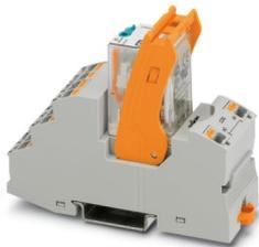
Vormontiertes Relaismodul mit Push-in-Anschluss, bestehend aus: Relaissockel, Leistungskontaktrelais und Haltebügel. Kontaktausführung: 2 Wechsler. Eingangsspannung: 24 V DC
