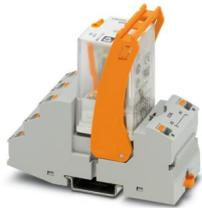
Vormontiertes Relaismodul mit Push-in-Anschluss, bestehend aus: Relaissockel, Leistungskontaktrelais, steckbarem Anzeige-/ Entstörm modul und Haltebügel. Kontaktausführung: 3 Wechsler. Eingangsspannung: 120 V AC
