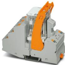
Vormontiertes Relaismodul mit Push-in-Anschluss, bestehend aus: Relaissockel, Leistungskontaktrelais, steckbarem Anzeige-/ Entstörm modul und Haltebügel. Kontaktausführung: 3 Wechsler. Eingangsspannung: 230 V AC
